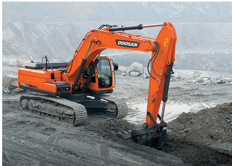
Figura 2.7: Retroexcavadora con ruedas oruga
