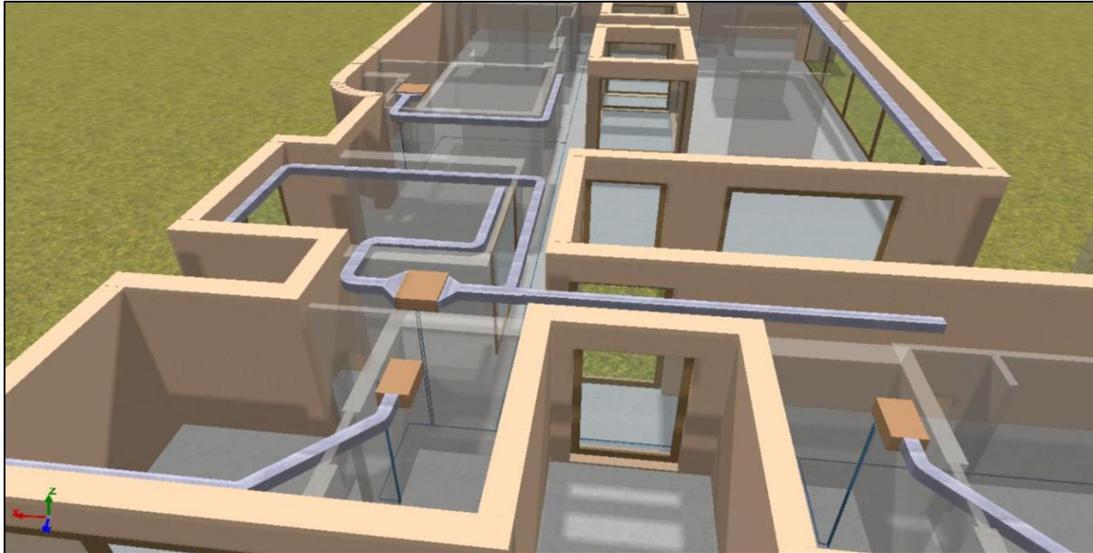
Figura 37. Vista desde el dormitorio 3 del conjunto climatizador centralizado por conductos.
