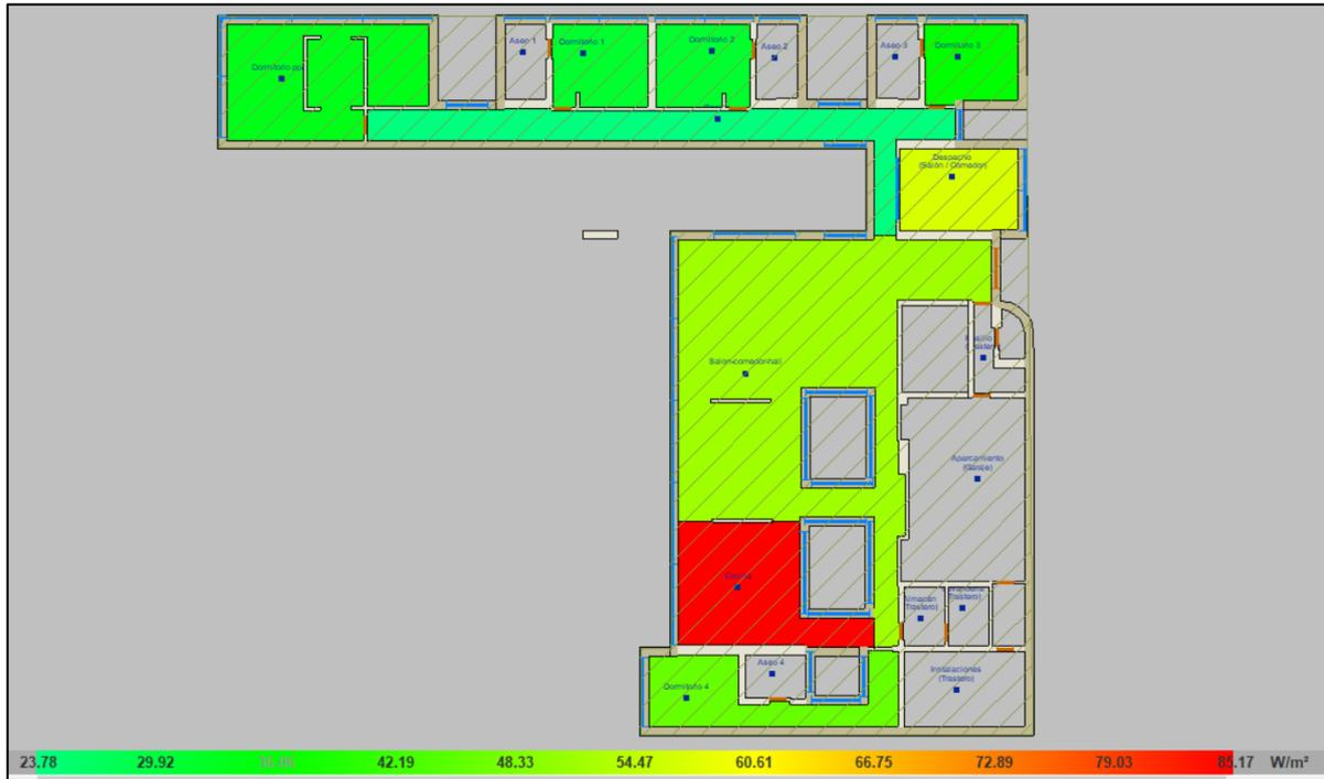
Figura 17. Plano en planta de la potencia térmica de refrigeración por superficie.
