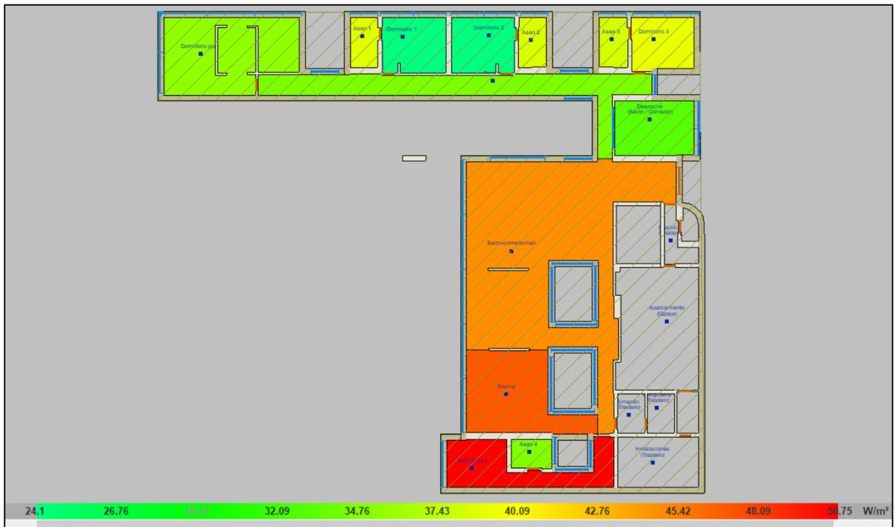
Figura 18. Plano en planta de la potencia térmica de calefacción por superficie.
