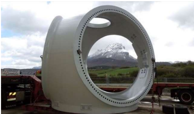
Figura 46. Buje de un Aerogenerador. Fuente: Structuralia Blog
