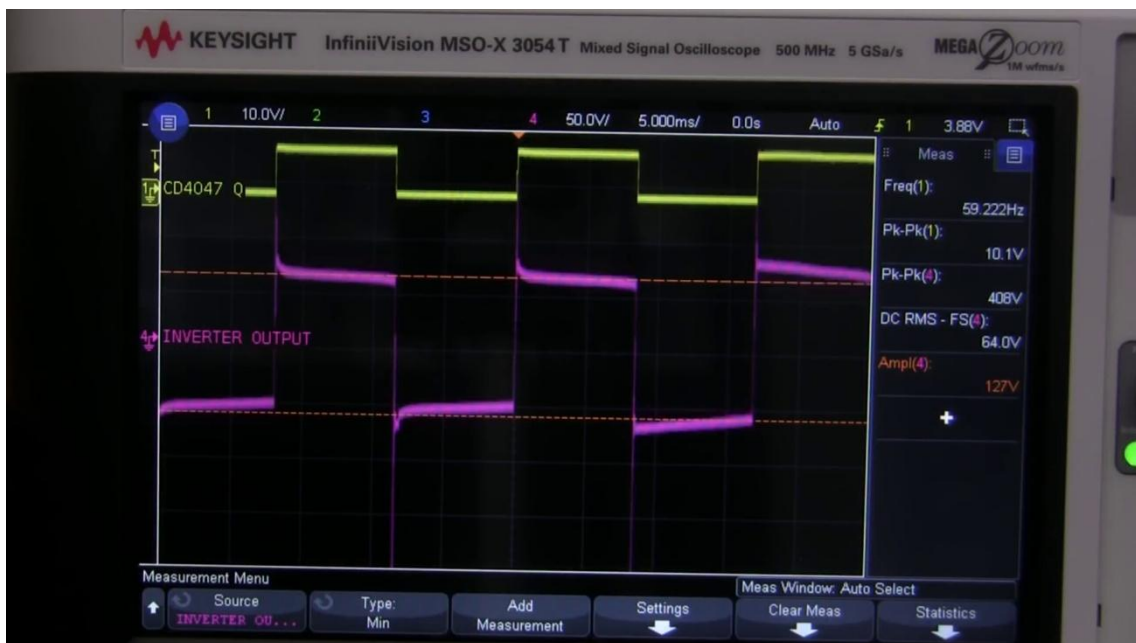
Figura 13. Salida de un "inversor" construido según los planos que se pueden encontrar en Internet, (Afrotechmods, 2016).
