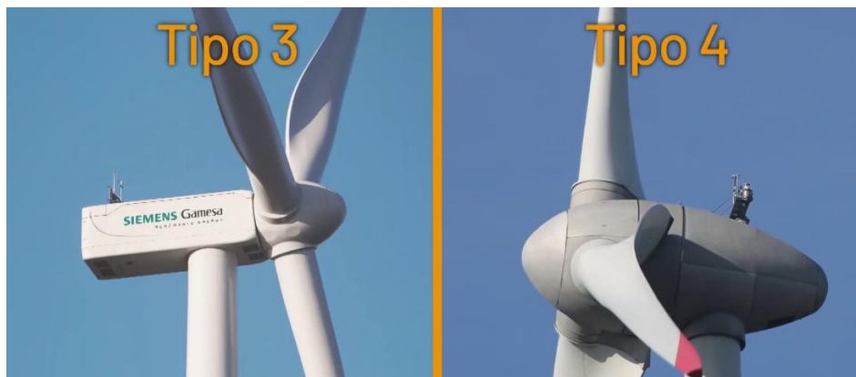
Figura 5. Comparación de como se ve por fuera un aerogenerador tipo 3 y un aerogenerador tipo 4 (Lijó, 2020).
