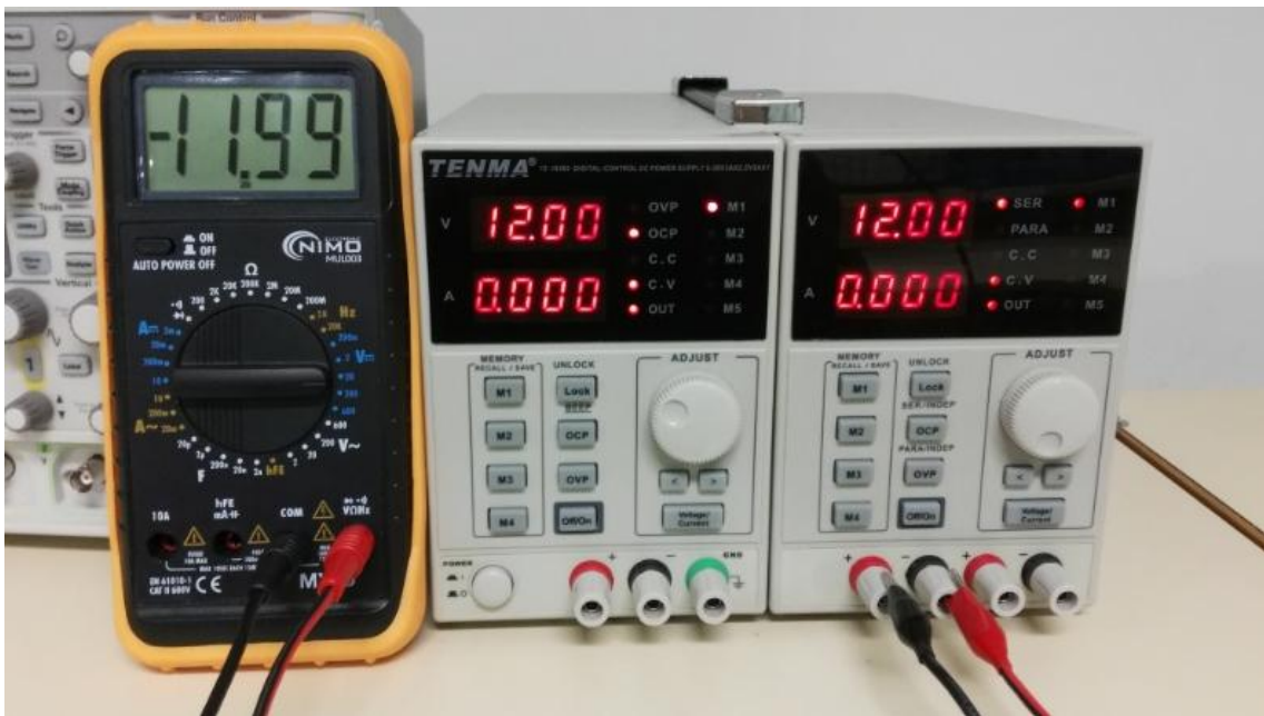
Figura 69. Medición de -12 V en la fuente doble del laboratorio en su configuración serie.
