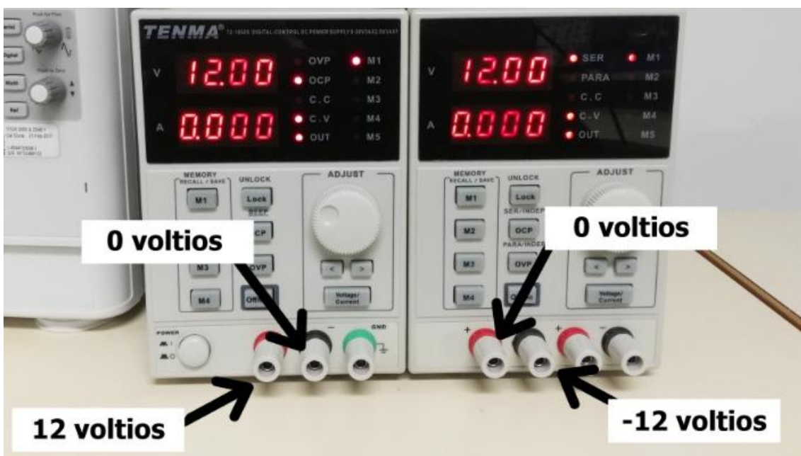
Figura 67. Tensiones en la fuente de continua tras configurarla en 12 V y modo serie.
