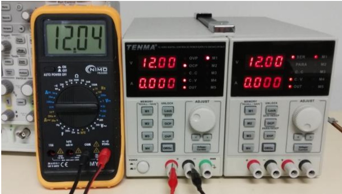
Figura 68. Medición de 12 V en la fuente doble del laboratorio en su configuración serie.
