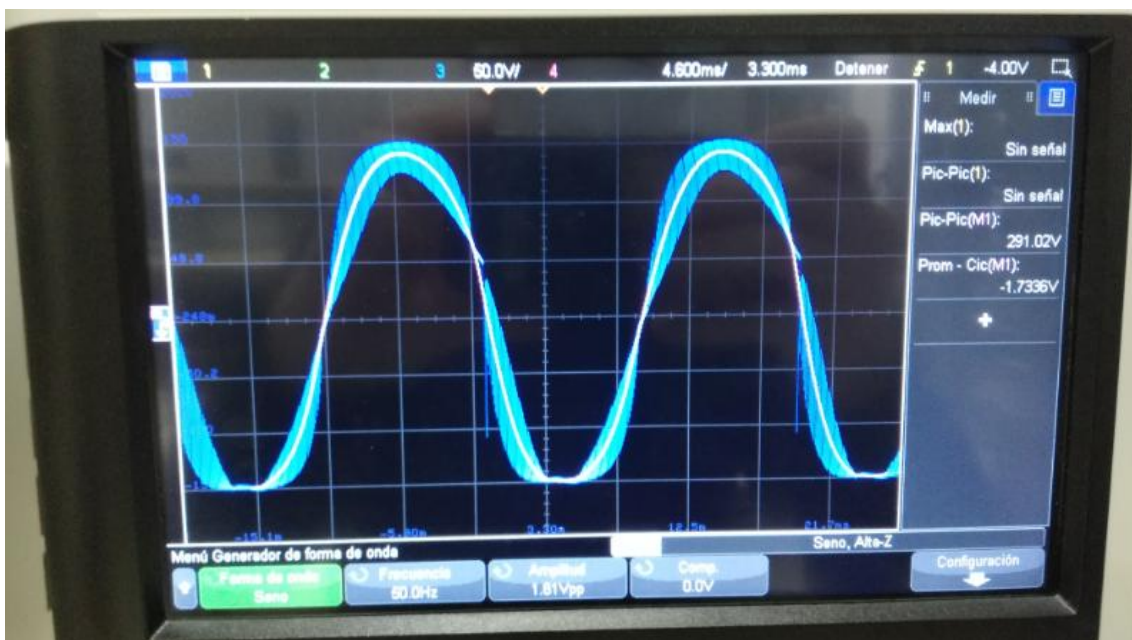
Figura 52. Salida después de bajar el valor de las resistencias encargadas de controlar la componente de continua.
