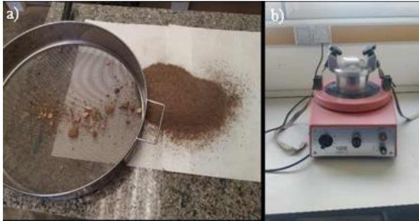
Figura 5. (a) Tamiz para la separación de la fracción “tierra fina” (>2 mm), fracción “gruesa” (rechazo del tamiz). (b) motero de ágata para la molienda fina de la muestra.
