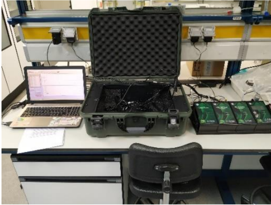
Figura 10. Kit de respiración del suelo Q-BOX SR1LP, basado en la determinación de CO 2 mediante analizador de infrarrojos.
