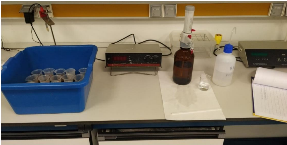
Figura 7. Conductímetro y pH metro junto con las muestras para la determinación de los parámetros de conductividad eléctrica y pH.
