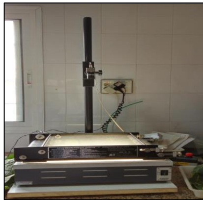
Fotografía 6.- Planímetro electrónico (Delta-T Devices LTD, Cambridge, Reino Unido).
