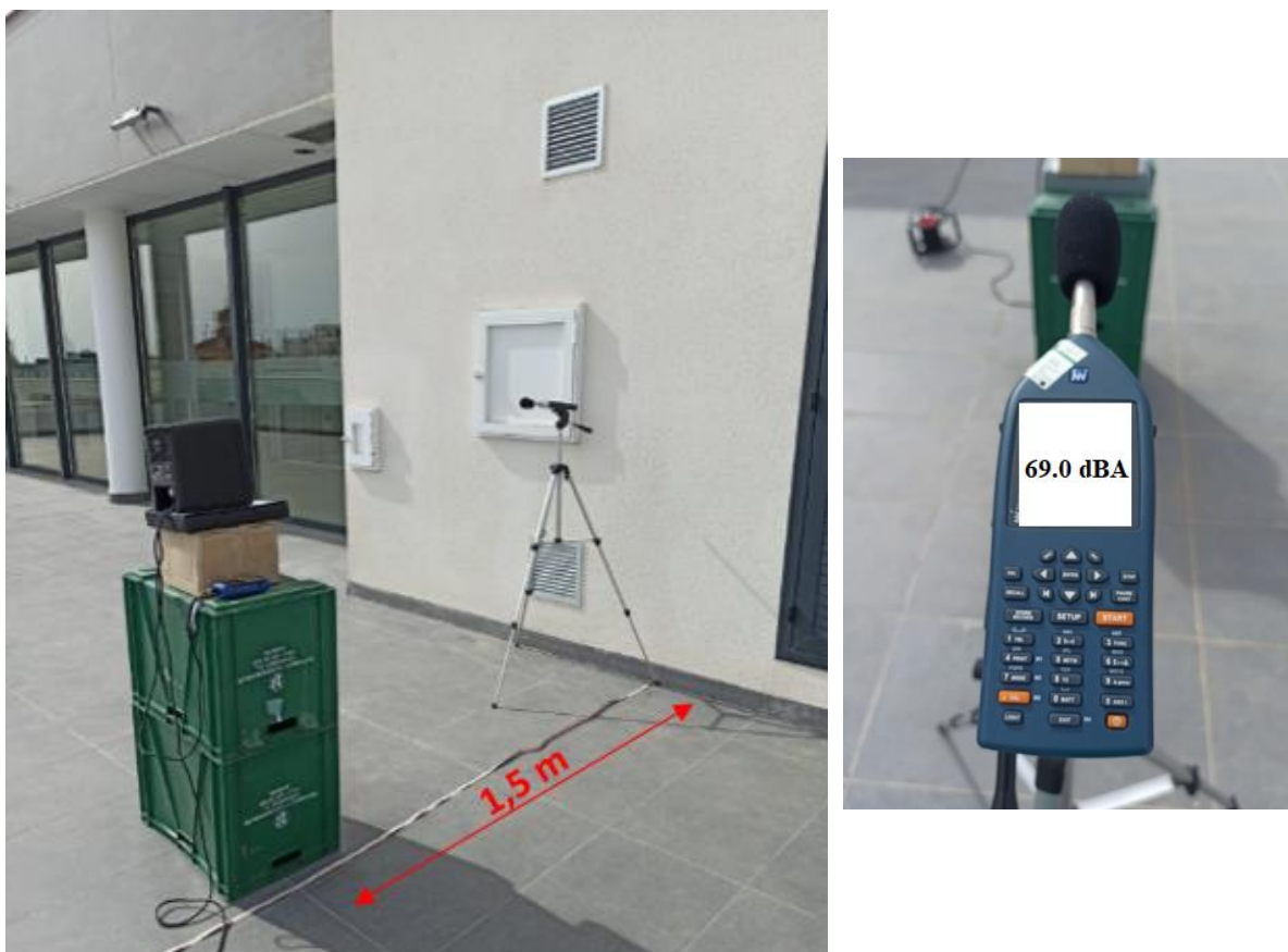
Figura A2.3. Medición n° 2 – Configuración terraza adosada a fachada (Fuente: Elaboración propia).
