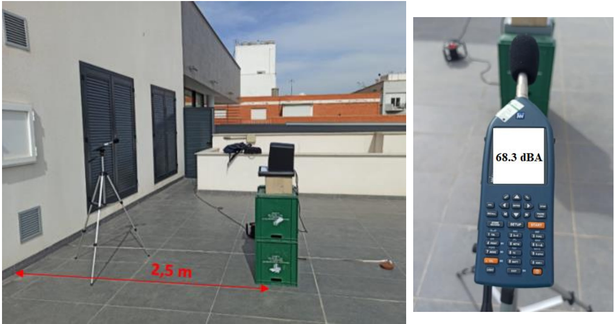
Figura A2.4. Medición n° 3 – Configuración terraza separada de fachada (Fuente: Elaboración propia).
