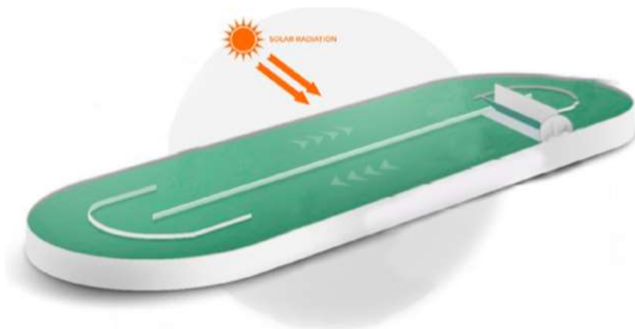
Figura 17. Reactor tipo raceway [16]
