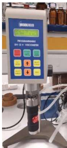
Figura 4.4.- Viscosímetro empleado en la experimentación: a) detalle del enganche de husillo al motor, husillo (ULA) y cilindro externo; b) sistema montado para la medida de la viscosidad de las muestras.
