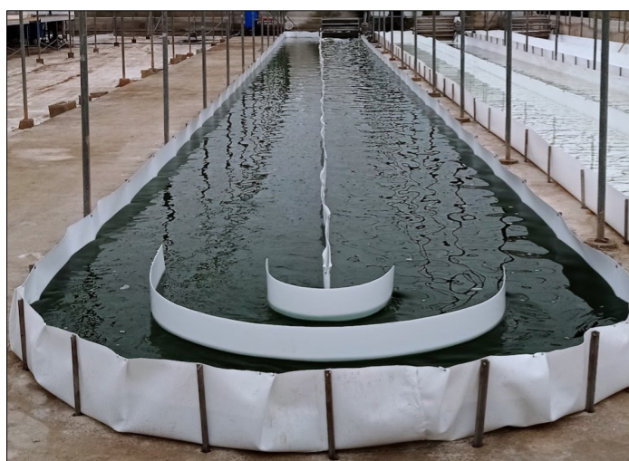
Figura 1. Fotobiorreactor raceway implementado en Centro de Investigación IFAPA, Universidad de Almería, España.
