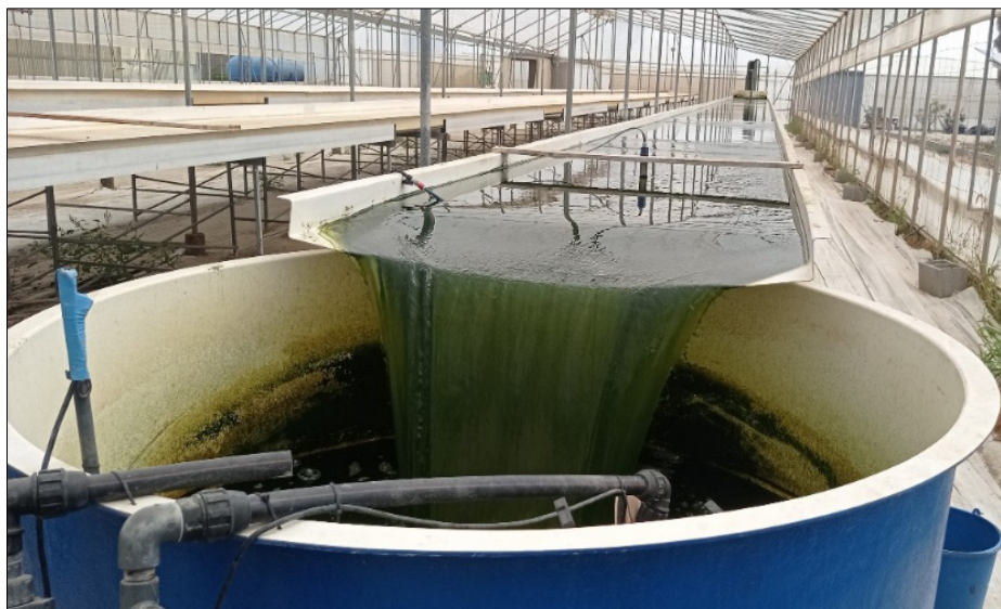
Figura 2. Fotobiorreactor de capa fina implementado en Centro de Investigación IFAPA, Universidad de Almería, España.
