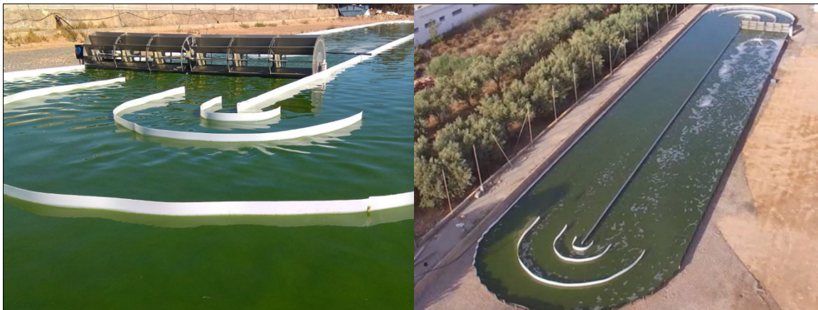
Figura 3. Imágenes del reactor raceway utilizado instalado en la Estación Experimental Las Palmerillas, Almería, España.
