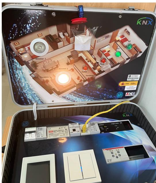
Figura 4.1: Laboratorio físico de pruebas que simula una instalación de casa inteligente basada en el protocolo KNX.
