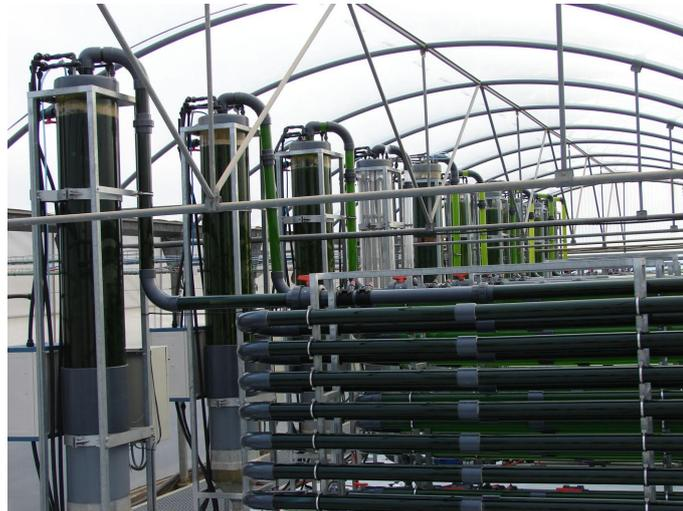
**Figura 1.1:** Reactores tubulares de la Universidad de Almería (UAL)
