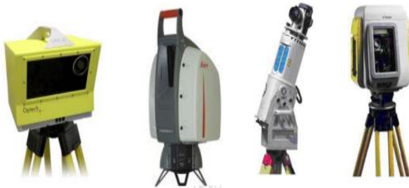
Figura 2. Escáneres basados en el tiempo de vuelo. (Lerma García, J. L., & Biosca, J. M. 2008)
