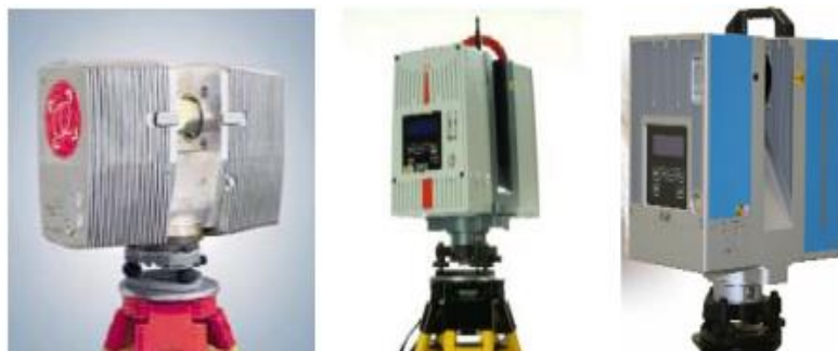
Figura 6. Escáneres comerciales basados en la diferencia de fase. (Lerma / Biosca - Teoría y práctica del Escaneado Láser Terrestre)
