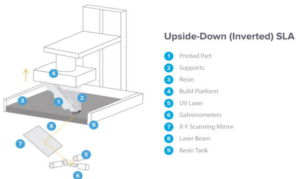
Figura 16. Esquema de funcionamiento tecnología SLA. ( https://3dneworld.com/la-guia-de-impresion-de-estereolitografia-sla-en-3d/ )
