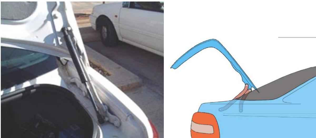
Figura 4. 30. Ejemplo aplicación mecanismo cuatro barras
