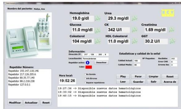
**Figura 3.** Aplicación SCADA del receptor que recibe la información de los datos hematológicos.
