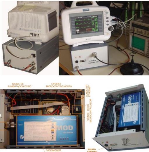
**Figura 2.** Unidad móvil de comunicaciones conectada a los equipos médicos.
