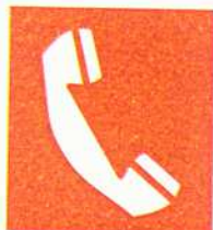
Teléfono para la lucha contra incendios
