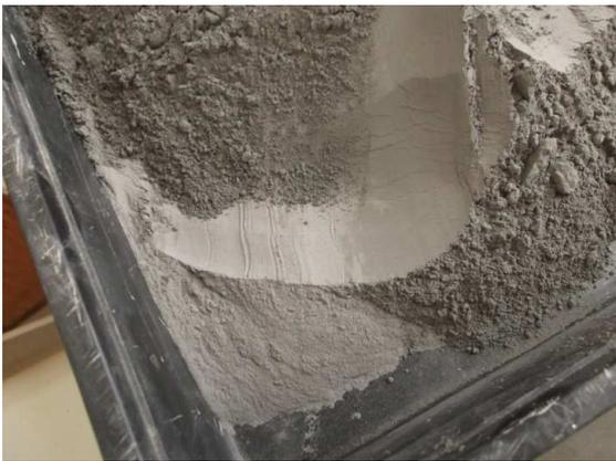
Figura 7. Recipiente con filita ya triturada en la que se aprecian tres tonalidades distintas.
