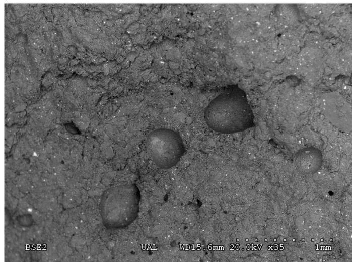
**Figura. 9. Imagen del MEB ampliada x35 (probeta 10% cemento y 90%filita).**
