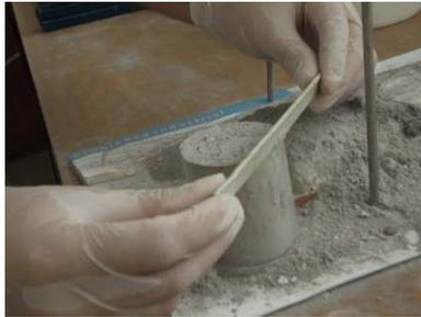
Figura 3. Enrasado de la probeta.
