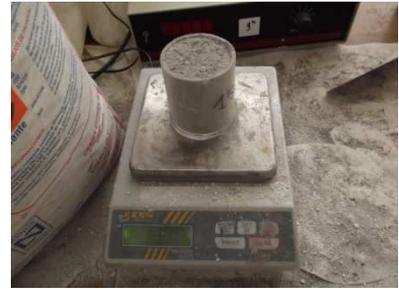
Figura 4. Pesaje de la probeta una vez llena.
