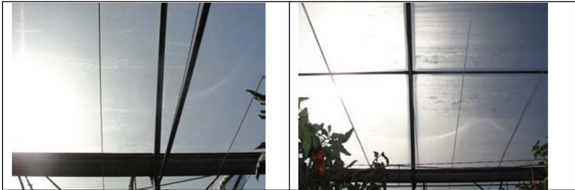
Figura 8. Vista del film plástico NIR (sin condensación) y film convencional (con condensación).
