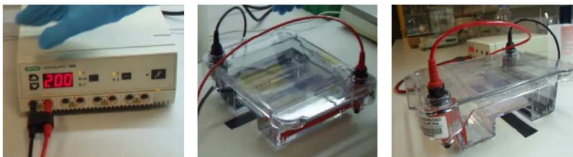
Figura 9. Fuente de alimentación y cubeta de electroforesis con conexiones.
