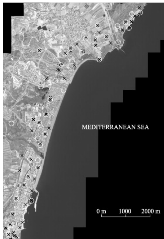
Figura 12. Situación de los 120 puntos de control, 51 GCPs (marcados como cruces) y 69 ICPs (marcados como círculos) sobre la zona de trabajo.
