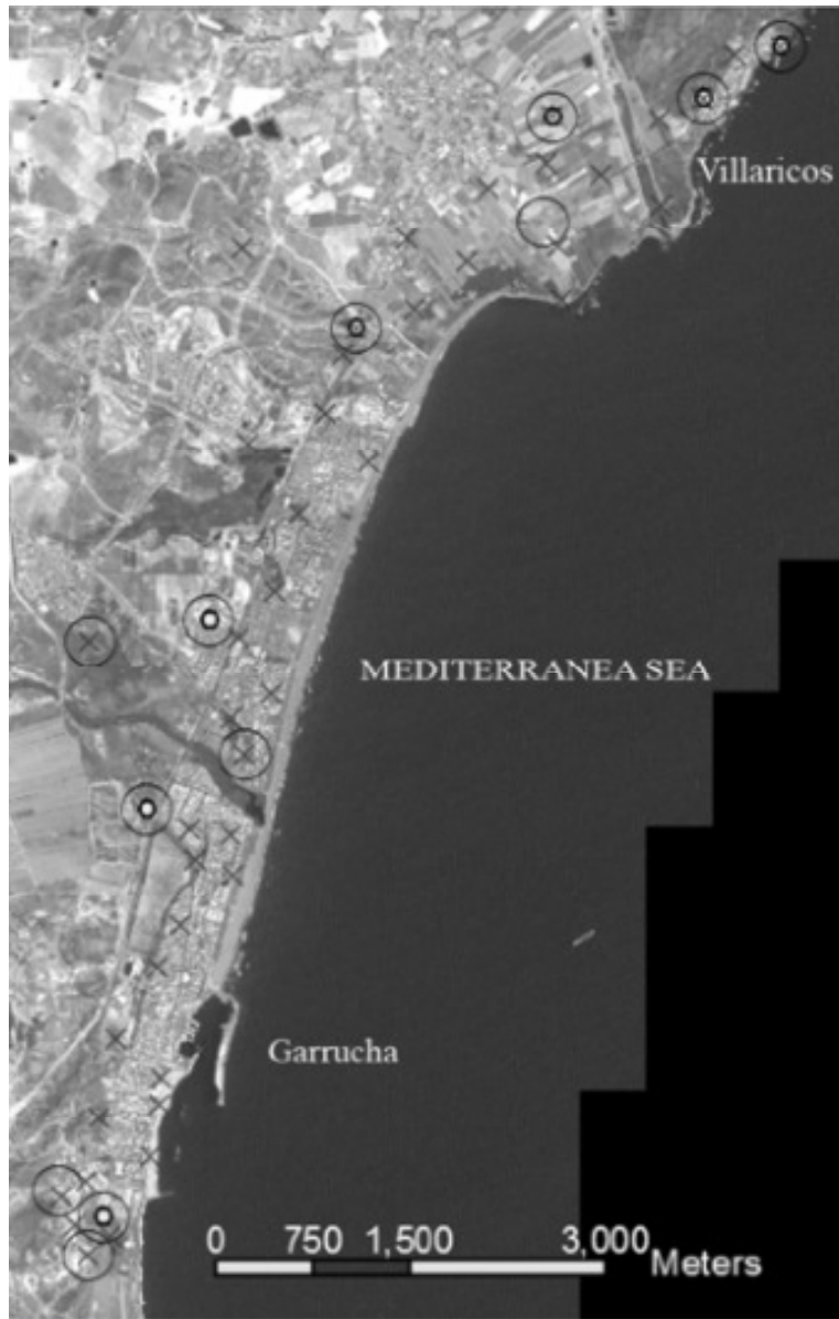
Figura 14. Distribución de los 45 GCP (cruces), 12 GCP (círculos grandes) y 7 GCP (círculos pequeños) superpuestos sobre una ortofotografía panromática de GEI .
