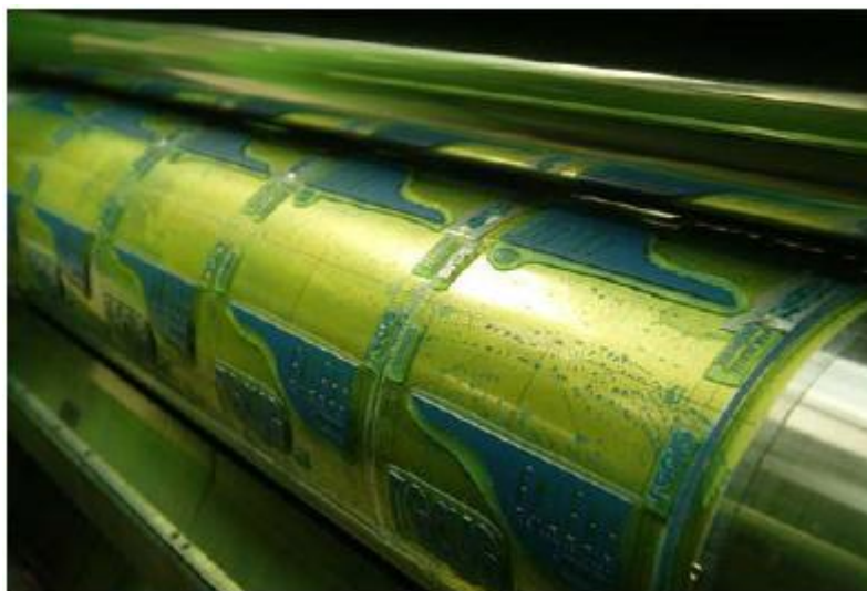
Ilustración 2: Detalle de un cliché
