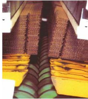
Ilustración 5: Detalle de separado del punto de enganche
