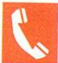
Teléfono para la lucha contra incendios
