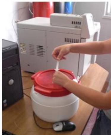
FIGURA 22: Metodología seguida para la determinación de la producción de etileno de los frutos de las diferentes variedades de calabacín ( Cucurbita pepo ) (Elab. propia).
