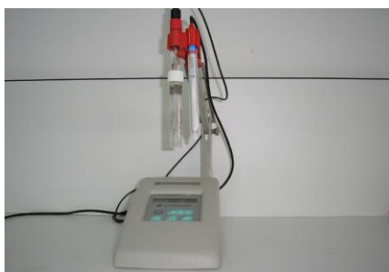
Imagen 4.1.2.2. pHmetro Crison micro pH 2001 con electrodo de vidrio y sonda de temperatura.
