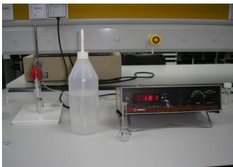
Imagen 4.1.2.4. Conductivímetro Crison 522 con electrodo de vidrio.
