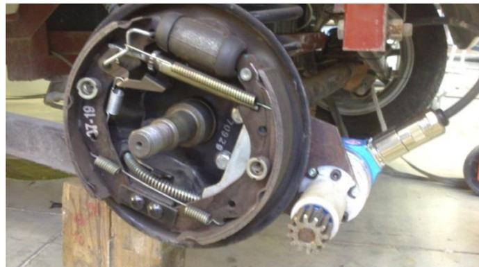
**Figuras 3.5.10 y 3.5.11: Codificador y conjunto de piñón montados sobre el vehículo**
