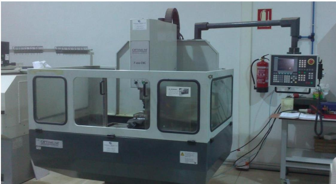
Figura 3.3.1: Imagen general de la fresadora
