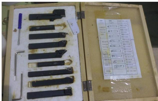
**Figura 3.3.10: Catálogo de herramientas de corte**
