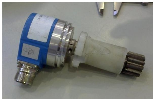
**Figura 3.5.8: Situación del codificador respecto del conjunto anteriormente ensamblado**
