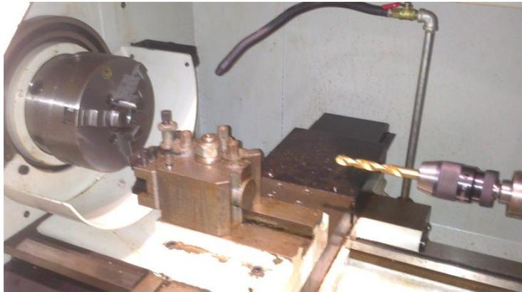
**Figura 3.3.8: Plato de sujeción de la pieza y porta-herramientas**
