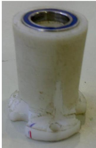
**Figura 3.5.3: Rodamiento insertado en soporte**
