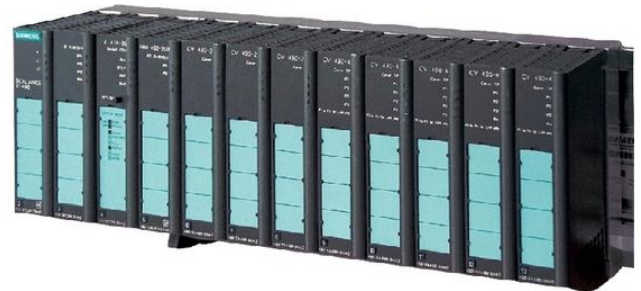
Figura 36. Switch SCALANCE X414 de la marca Siemens® utilizado para la comunicación Ethernet entre los distintos PC's y servidores del sistema, entre ellos y con los PLC's.
