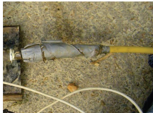
Figura 85. Tubería flexible rota
