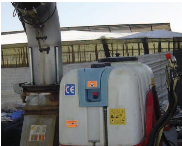
Figura 52. Depósito de agua limpia de 15L de volumen
