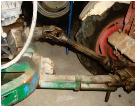
Figura 62. Toma de fuerza sin protección
