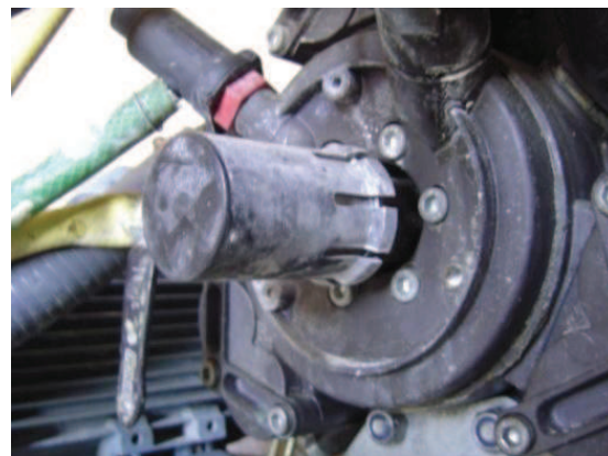
Figura 61. Protección toma de fuerza inadecuada
