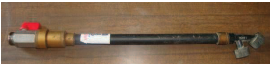
Figura 103. Lanza con filtro en impulsión incorporado
