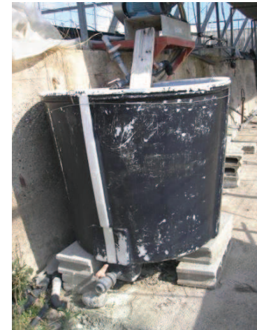
Figura 51. Vaciado directo al suelo
