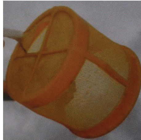
Figura 37. Filtro en mal estado
