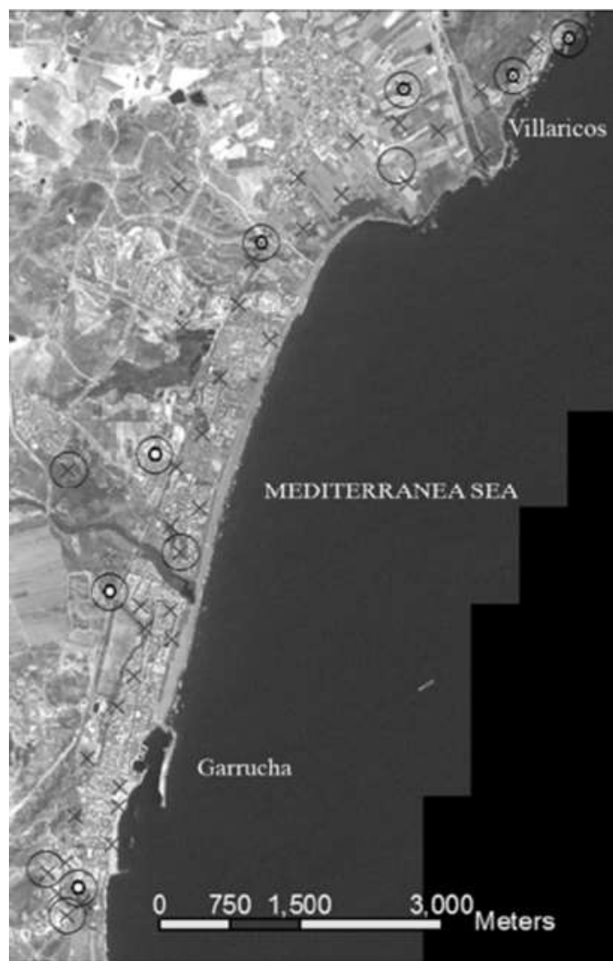
Figura 14. Distribución de todos los puntos en toda la comarca, incluyendo los 12 GCP (círculos grandes). Las cruces identifican los 69 ICPs
