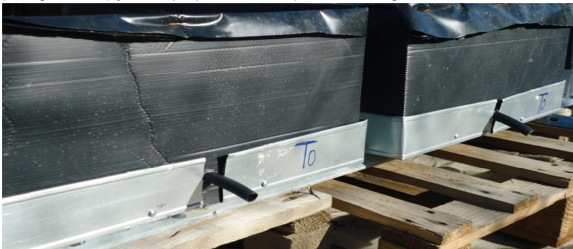
Fotografía 3.7. Vista del drenaje de la simulación de cubierta ajardinada.
