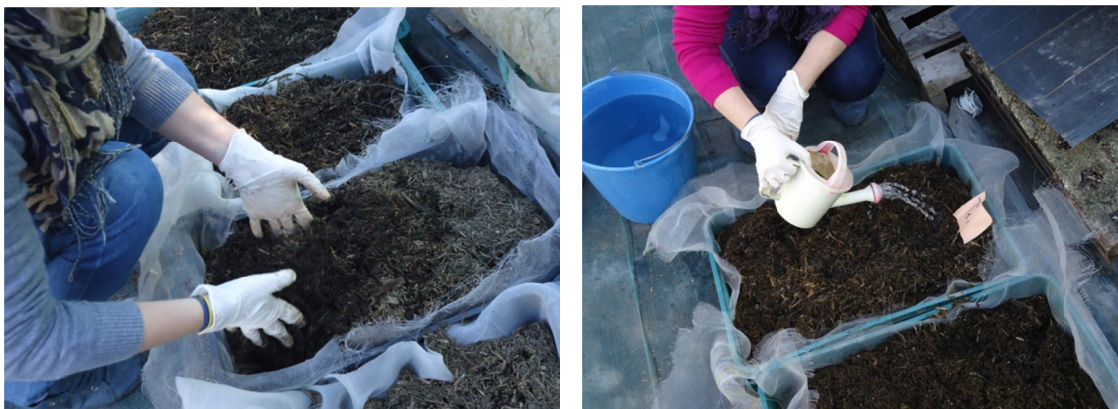
Fotografía 3.9. Preparación de la mezcla de sustratos para cada simulación de cubierta. Mezcla y volteo (izquierda) y riego para humedecer la mezcla (derecha).
