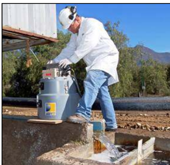
Figura 2.40.- Instalación de un muestreador puntual y continuo (DICTUC, 2013)
