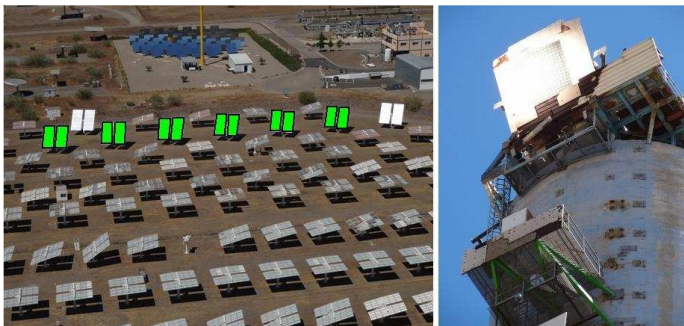
Figura 6.19. Estado del sistema en el instante t2, los helióstatos 143, 144, 145, 146, 147 y 148 están enfocados
