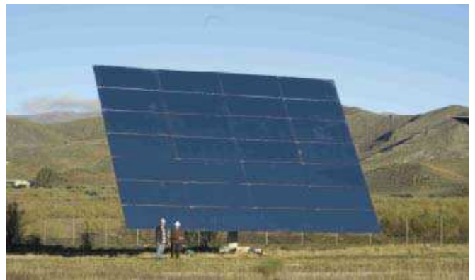
Figura 2.1. Helioestato de 120 m 2 diseñado por Solúcar S.A.
