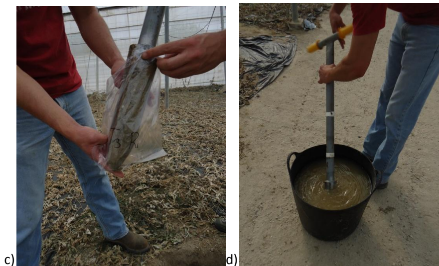
Figura 22. a)Detalle de la eliminación de la capa superficial de suelo con ayuda de una azada. b)Detalle de la extracción de la muestra de suelo con barrena. c)Detalle del embolsado de la muestra de suelo. d)Desinfección de la barrena.
