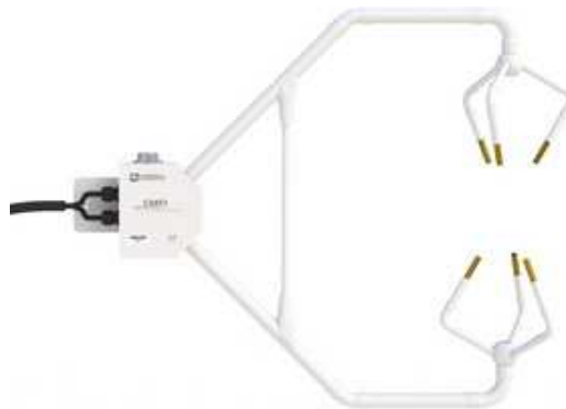
Figura 33. Anemómetro tri-dimensional. Imagen extraída de www.technosolutions.cn
