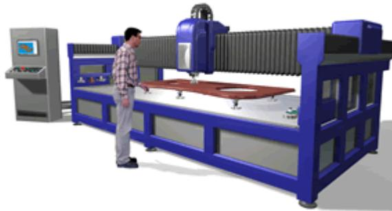
*Figura 5: Centro de mecanizado para el corte y elaborado de piedra natural*
