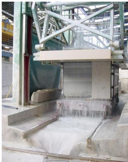
*Figura 2. Telar de corte de bloques de piedra natural*
