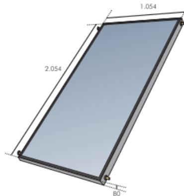
El absorbedor es de aluminio con recubrimiento selectivo de alta eficiencia "mirotherm" y parrilla de tubos 9 verticales y 2 horizontales de 8mm de diámetro y 0,5 mm de espesor.
