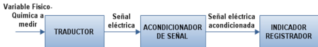
Figura 3.10 Componentes de un sensor
