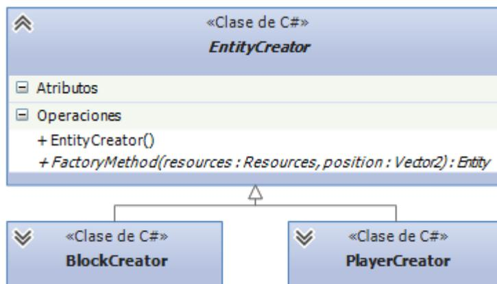
Figura 57. Diagrama de clases de Factory Method para la creación de entidades
