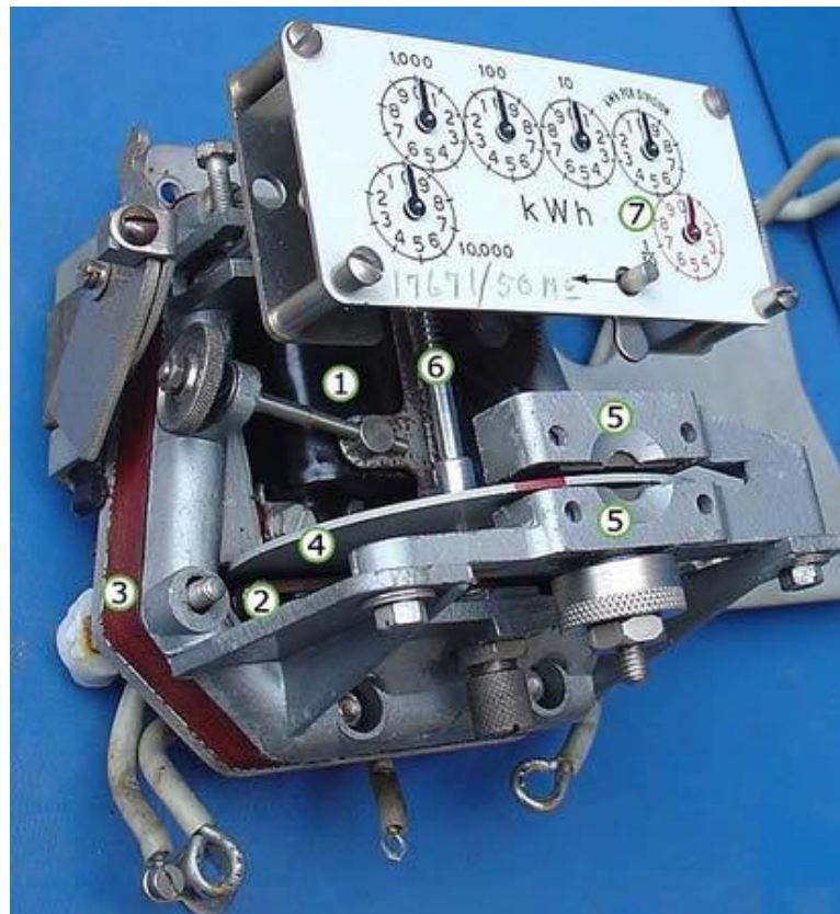
Figura 61: Contador analógico de electricidad (energía activa). Fuente: http://e-ducativa.catedu.es/
