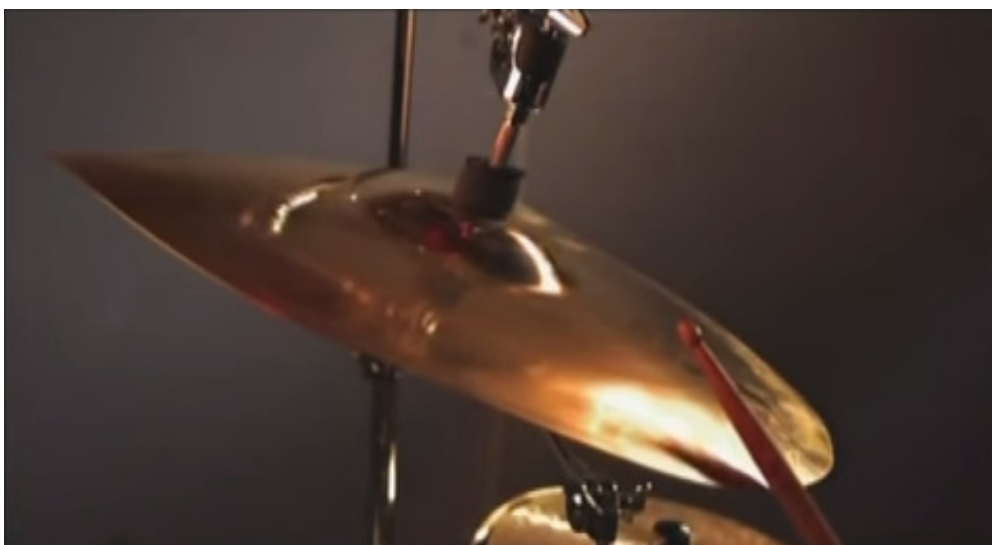
Figura 27: Deformación de una placa delgada (plato) a cámara lenta.
