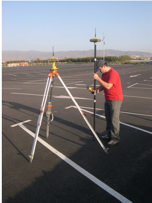
Figura 19. Equipo GPS bifrecuencia.
