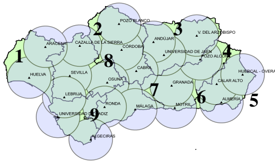
Figura 48. Cobertura para 5 cm de precisión.
