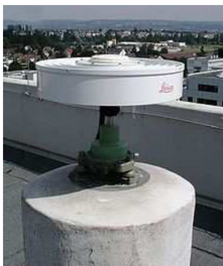
Figura 2. Estación de referencia DGPS perteneciente a la R.A.P
