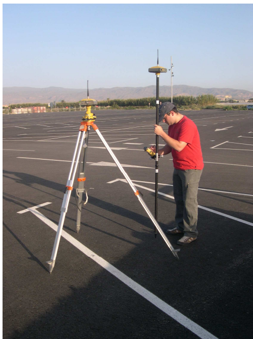
Figura 1. Estación y receptor GPS profesionales para precisiones centimétricas.
