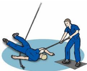
Fig. 10. Rescate en accidente eléctrico.
