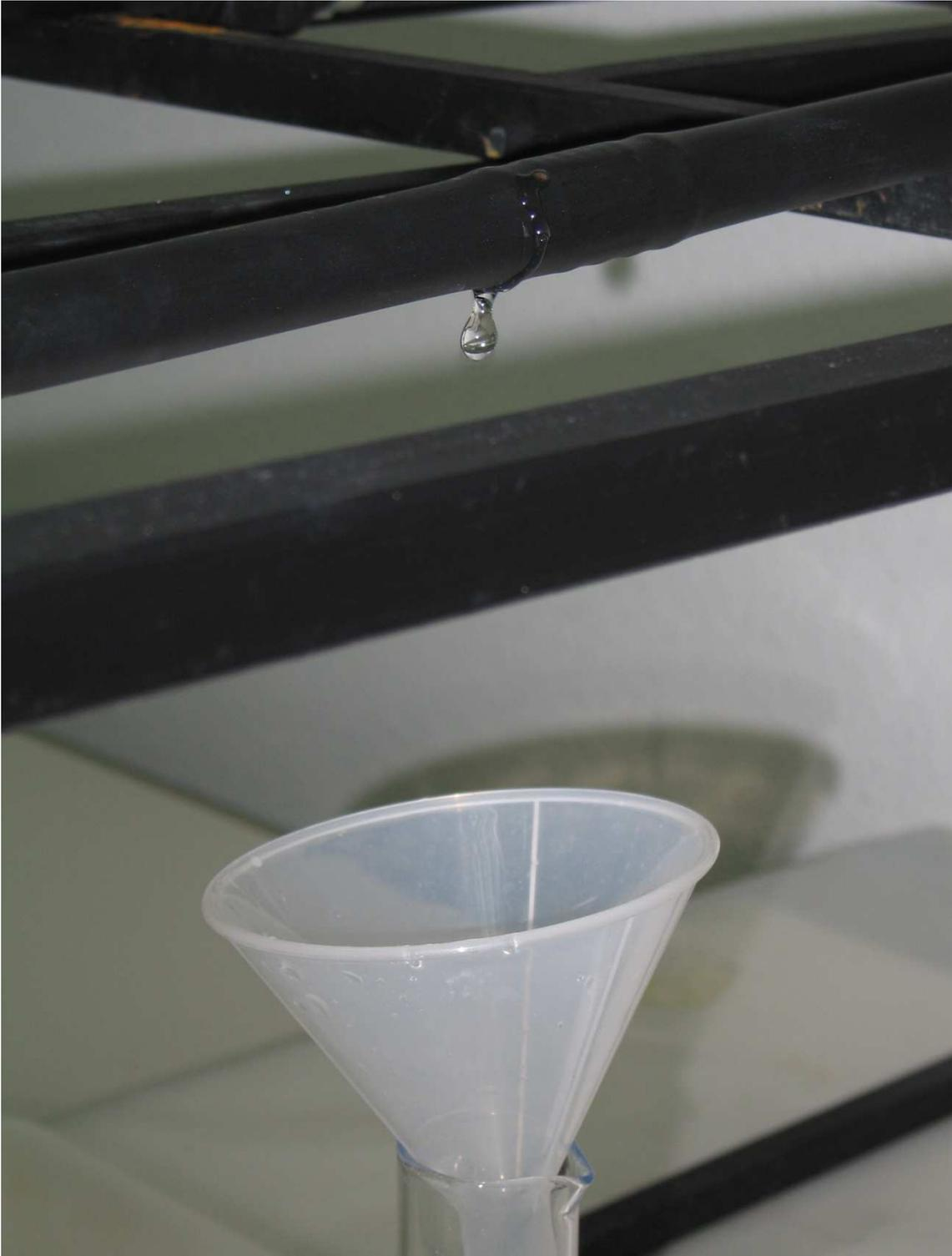
**Fotografía 13: Banco de ensayos en funcionamiento. Recogida de agua para el cálculo de la curva de gasto de los goteros.**
