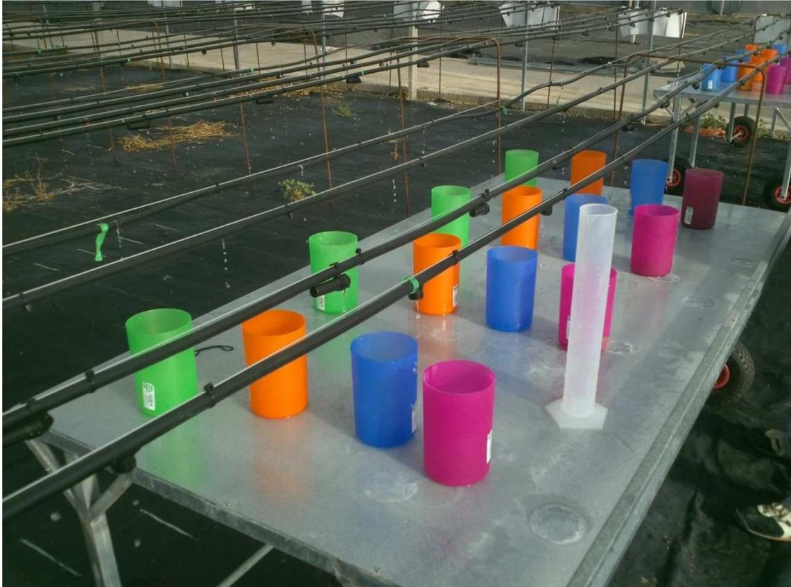
**Fotografía 25: Carros usados en el ensayo y colocación de éstos bajo las líneas de goteros.**
