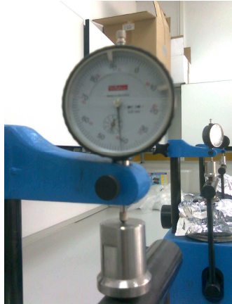
Figura 13: Detalle del comparador utilizado
