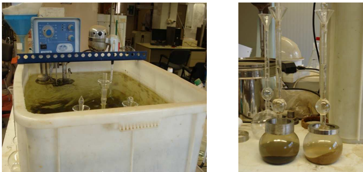
Figura 9. Equipo utilizado para hallar el peso específico y dos matraces con muestra.
