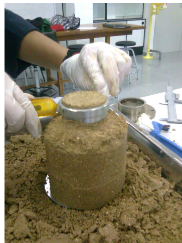
Figura 14: Esquema célula edómetro convencional Figura 15: Detalle del proceso de tallado
