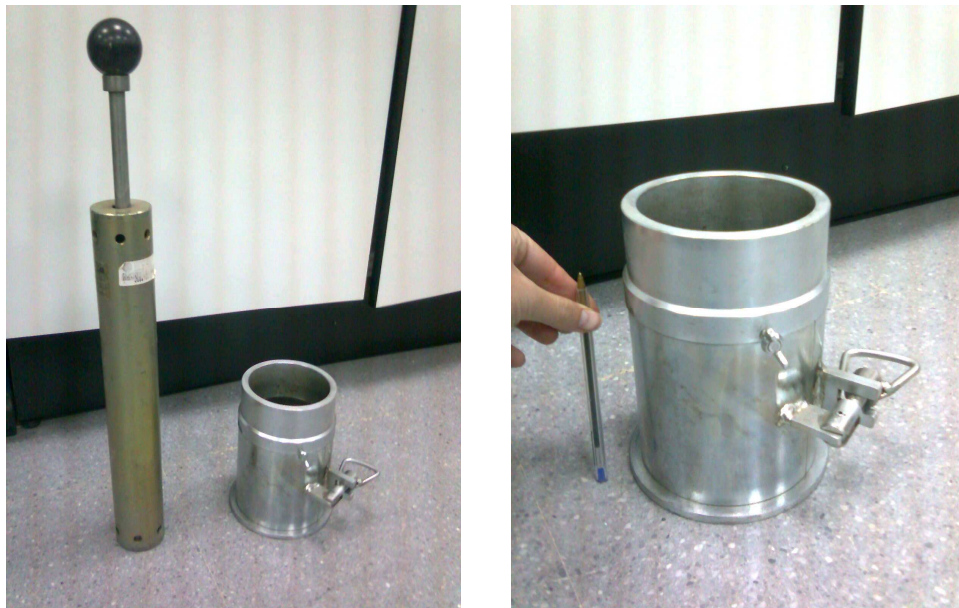
Figura 8. Molde de Proctor normal
