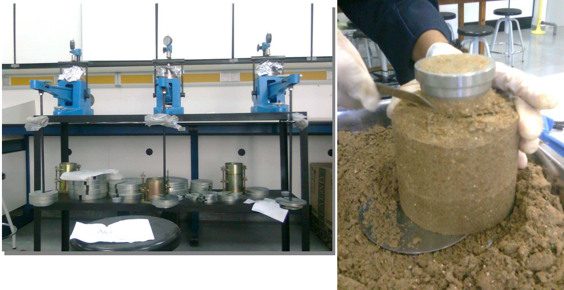
Figura 10. Equipo edométrico y detalle de la célula de carga con la muestra durante el proceso de tallado.
