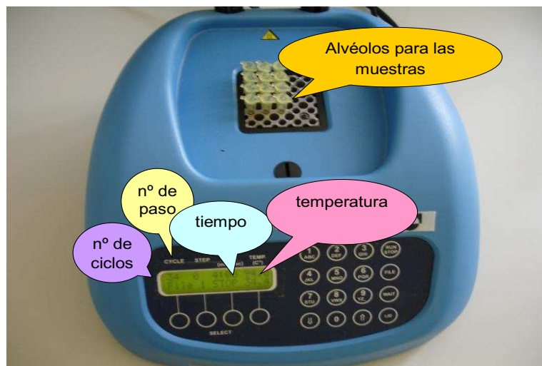
FIGURA 17: Termociclador donde podemos observar las diferentes partes para su programación y posterior funcionamiento.
