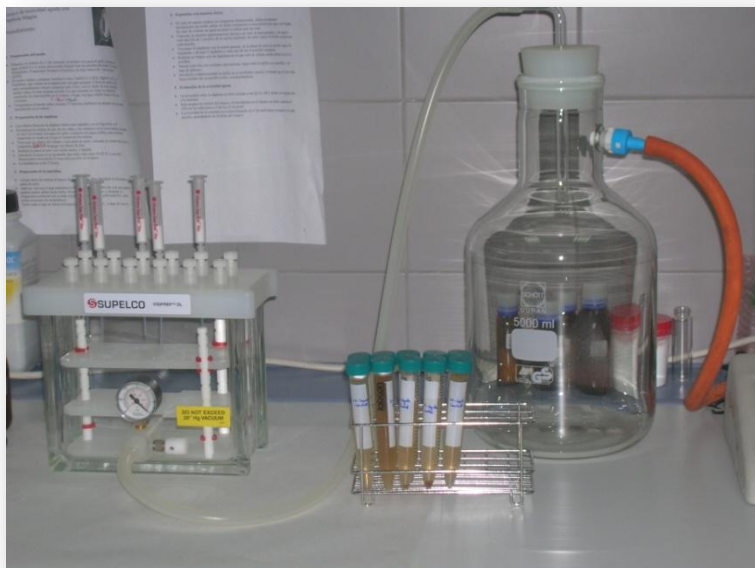
Figura 33. Equipo de extracción consistente en una bomba de vacío y 5 cartuchos de extracción SPE.
