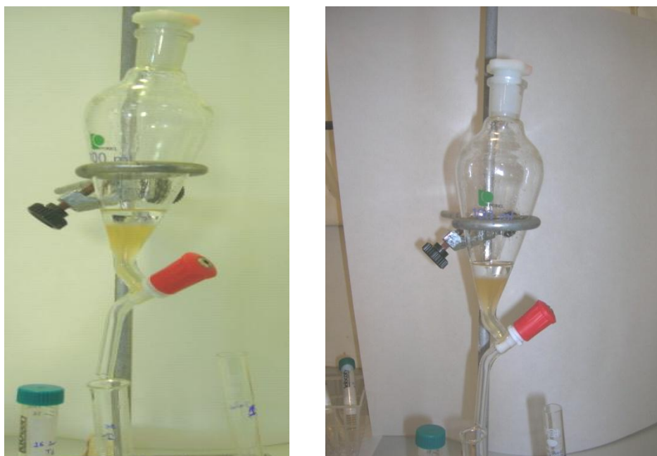
Figura 36. Diferentes vistas de la separación de fases: arriba las fitohormonas con el dietil-eter y abajo agua.
