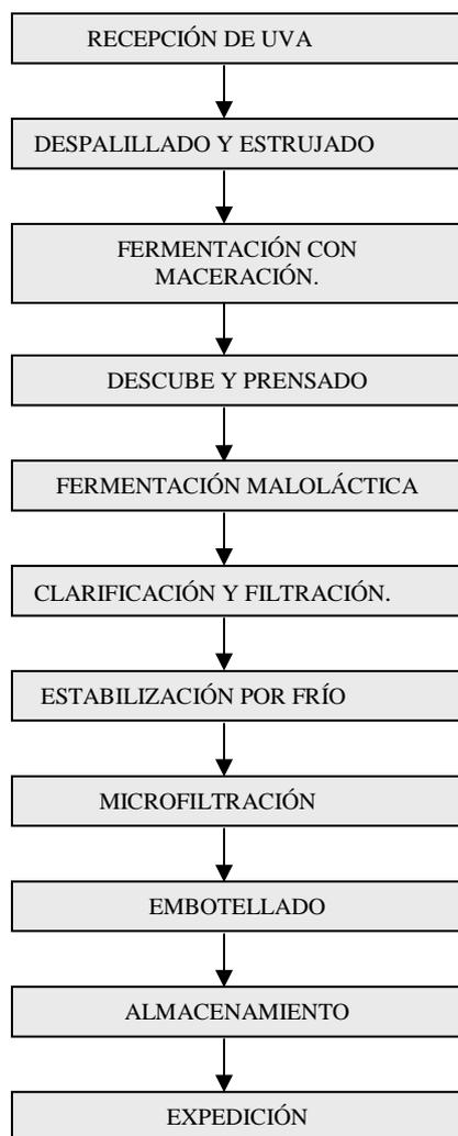
**Figura C. 3:** Diagrama de flujo para vino tinto en bodega Fuente Victoria S.A.
