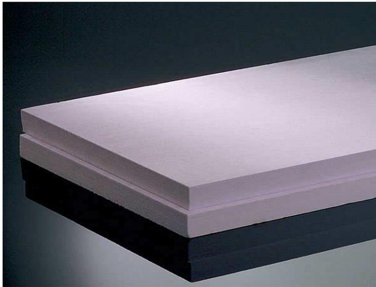
**Foto C. 12:** Imagen de paneles de poliestireno extruido
