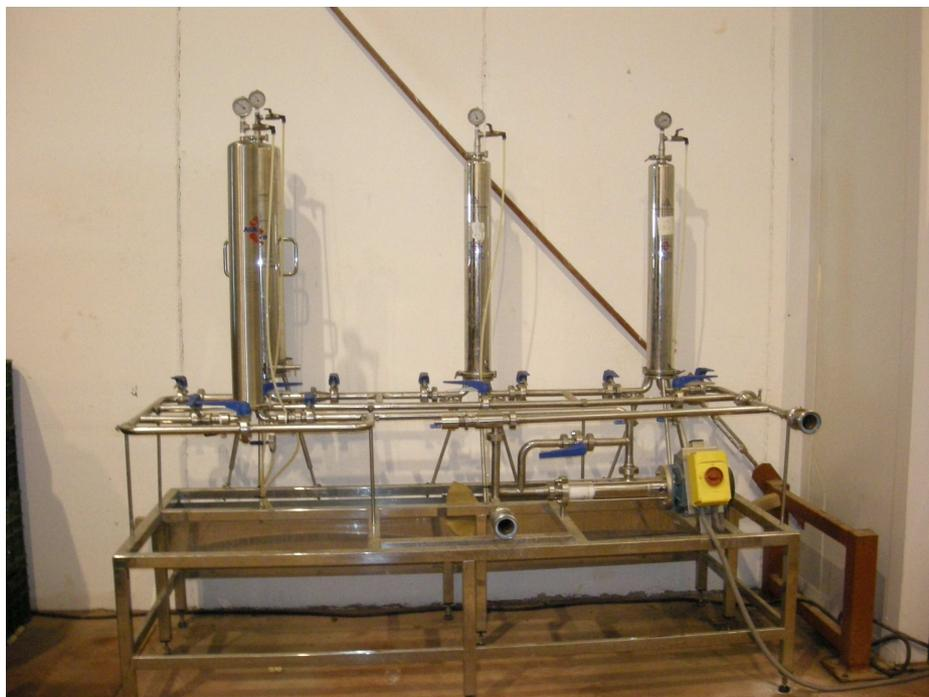
**Foto C. 5:** Instalación de microfiltración absoluta.
