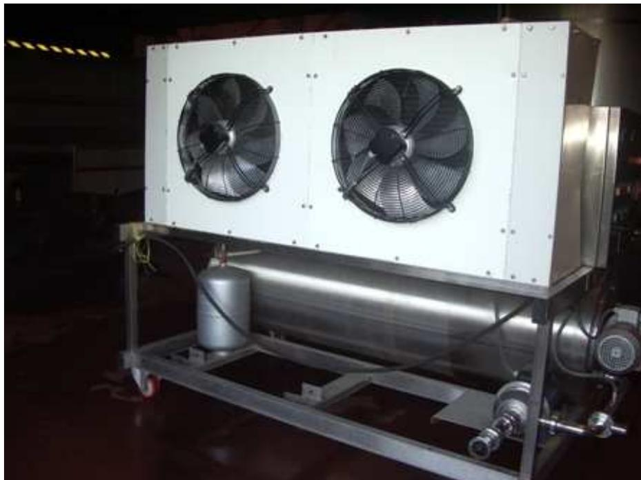
**Foto C.4:** Equipo de estabilización de cuerpo rascado.
