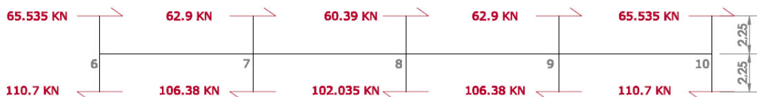
Figura 18: Cortantes en pilares del pórtico PX2 de la planta +1.
