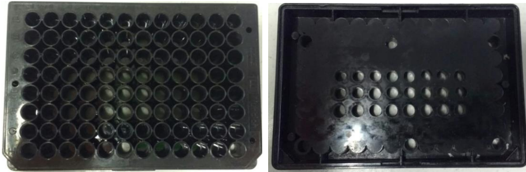
Figura 6. Placa perforada de 96 pocillos utilizada para cuantificar el ensuciamiento de los portaobjetos como una medida de fluorescencia.
