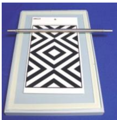
Figura 3. Sistema de esparcimiento de pintura compuesto por una varilla de aplicación espiral y una superficie de pruebas.
