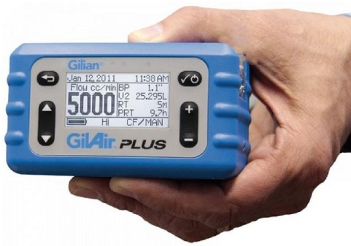
Ilustración 12. Modelo de bomba de muestreo usado. 16
