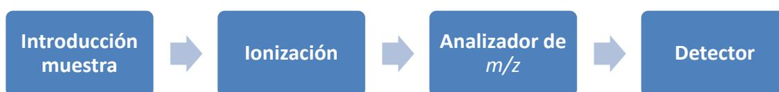
Figura 5: Diagrama en bloques de un espectrómetro de masas.
